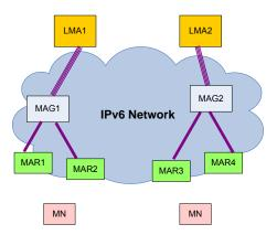
Figure 36. Hierarchical PMIPv6 Domain
